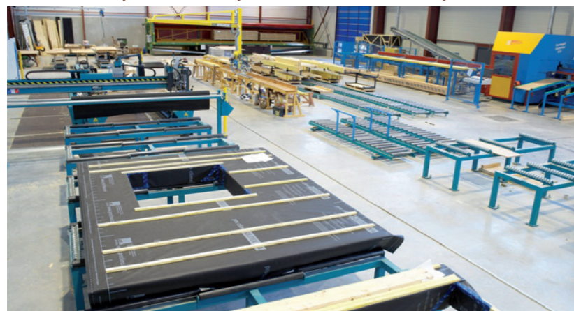
L'atelier avec au premier plan, la table d'assemblage de murs Mach V4 et à droite la Speed-Cut SC3 pour les montants et charpentes.
