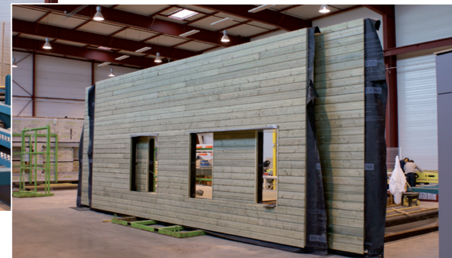
Le poste de bardage plongeant avec, au premier plan, la table papillon, tous deux conçus par Mach Diffusion. Un exemple des murs produits par le Bâtiment Associé.
